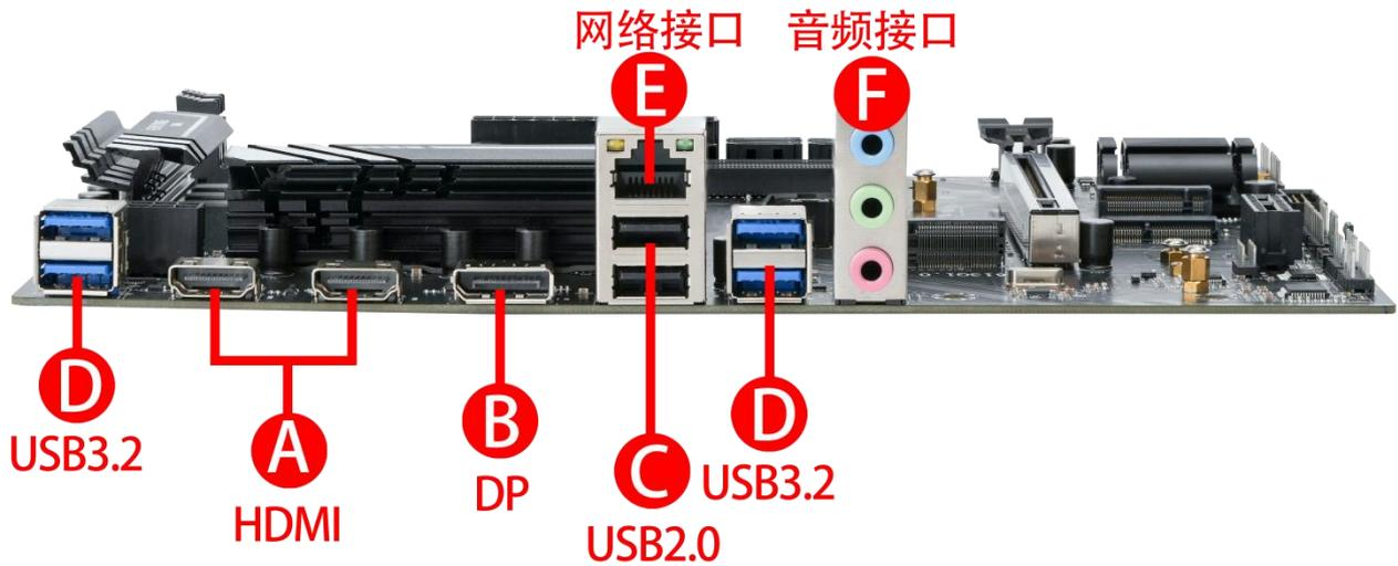
A: 2 个 HDMI2.0 接口：最高支持 4K@60Hz 屏幕显示。
